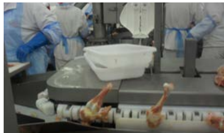
Os sistemas automatizados são superiores aos sistemas manuais para desossar carne escura com base no rendimento e na eficiência.
